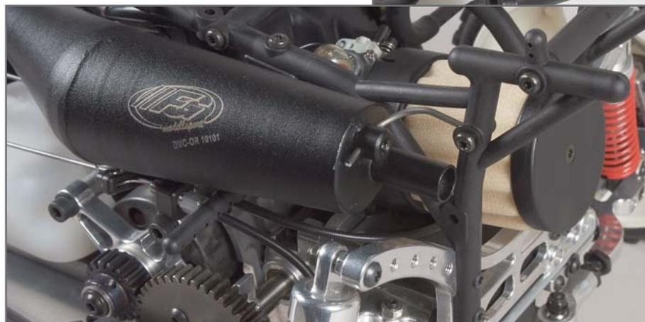
Zugfedern an Krümmer- und Schalldämpfering einhängen.
