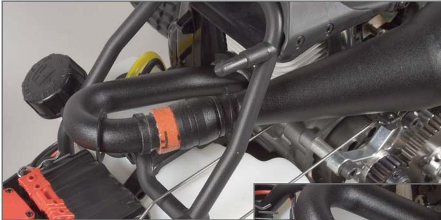
Krümmer mit Krümmerdichtung am Motor montieren. Danach Gewebeschlauch etwa 2/3 auf den Krümmer aufschieben und den roten Teil etwas mit Öl einreiben. Schalldämpfer mit vorsichtigen Drehbewegungen auf den Krümmer aufschieben.
