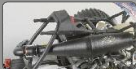
FG Steel-Power 1:6 Reso.schalldämpfer, Set FG Steel-Power 1:6 Tuning pipe, set FG Steel-Power 1:6 résonateur, kit Best.-Nr./ Item N°./ Réf. 06299
