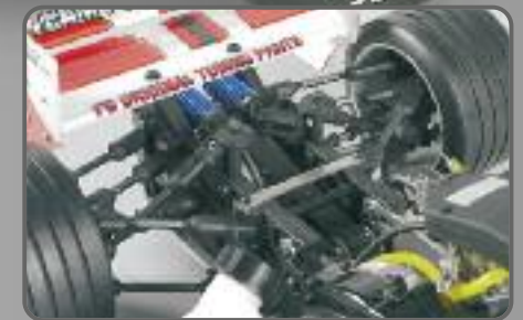
Die Hinterachse mit Doppel-Dreiecksquerlenkern, Alu-Öldruckstoßdämpfern und Zahnriemenantrieb mit wechselbaren Zahnriemenrädern aus Aluminium.
